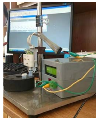
Montajul experimental cu senzorii fabricati pe filme organice subtiri, pe mini-platforma portabila
